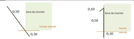
Figure 16 : Principe et caractéristique des clôtures contre l'intrusion des batraciens
